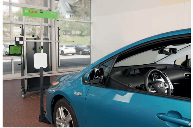
Toyota-etukamera: Peräkkäinen kalibrointi yhdellä tai useammalla kohdetaululla. Etäisyysmittausavustimen erittäin tarkka sijoitus OEM-vaatimusten mukaisesti.
